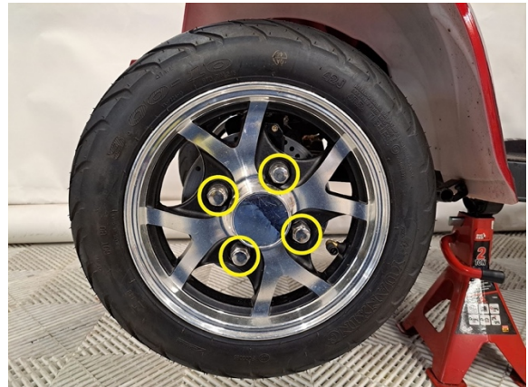
Irrota etupyörän kiinnitysmutterit. (hylsy 19 mm).
