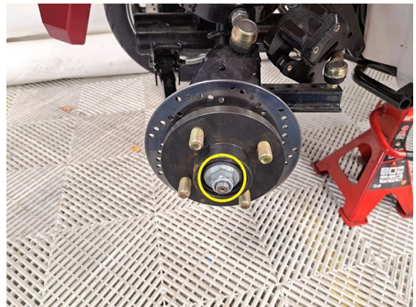
Irrota etupyörän navan kiinnitysmutteri. (hylsy 22 mm).
